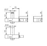
Triple cierre, resbalón y palancas, interior con bocallave y tirador para reclamo de resbalón, exterior con cilindro de 50 mm.
