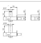
Triple cierre, sólo palancas, interior con bocallave, exterior con cilindro de 50 mm.
