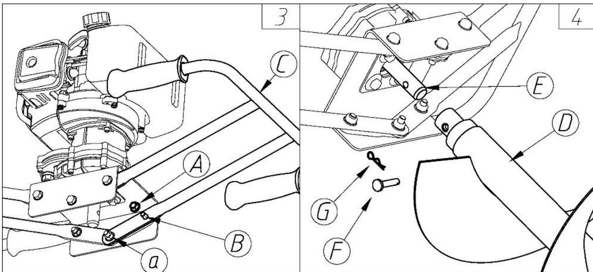
4. Setzen Sie den Bohrer (**Abb. 4, D**) auf den Schaft (**Abb. 4, E**) und sichern Sie diesen mit dem Bolzen (**Abb. 4, F**) und dem Splint (**Abb. 4, G**).
