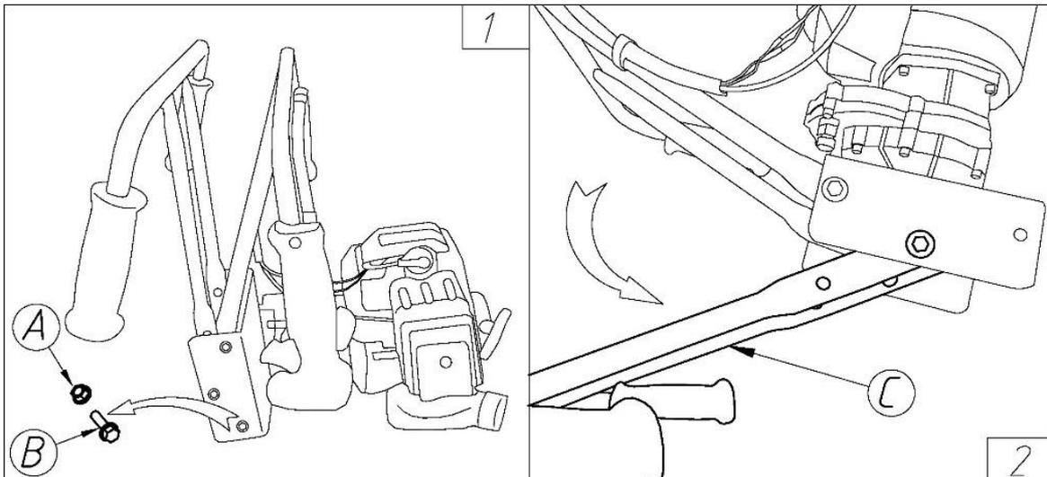
3. Entfalten Sie die beiden Griffhalterungen und befestigen Sie sie mit Hilfe der Muttern und Schrauben an der Verbindungsplatte und dem Stoßdämpfer (**Abb. 3**). Ziehen Sie die Schrauben fest.
