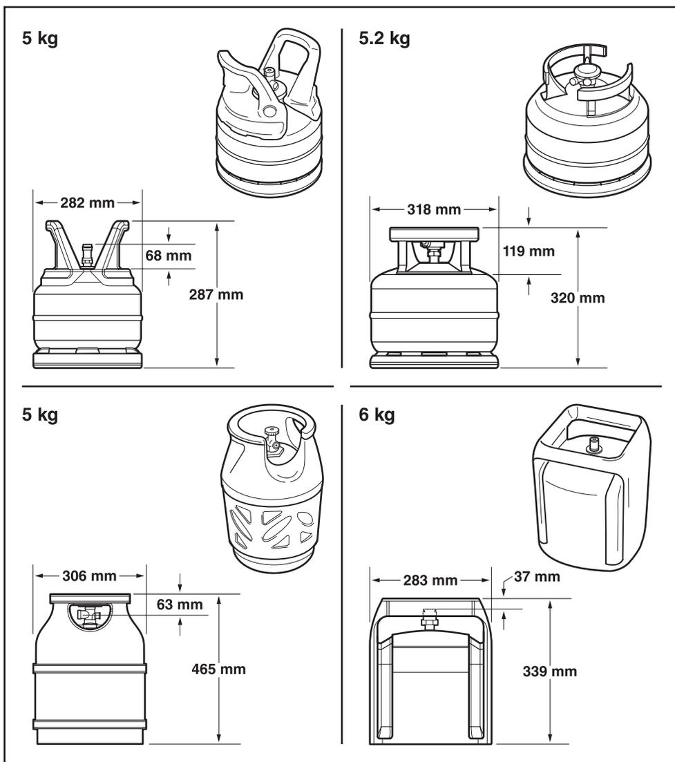
**La capacité maximale de la bouteille de gaz pour une installation à l'INTÉRIEUR du meuble est de 6 kg.**
