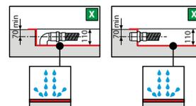
Per una ottimale tenuta si consiglia l'uso della nostra piletta di scarico **PIL90PCAB-CR40**, oppure di pilette di scarico dotate di guarnizione a doppio labbro
