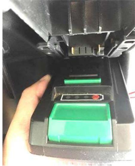
3. batterie installée en permanence. Déverrouillage avec bouton vert.
