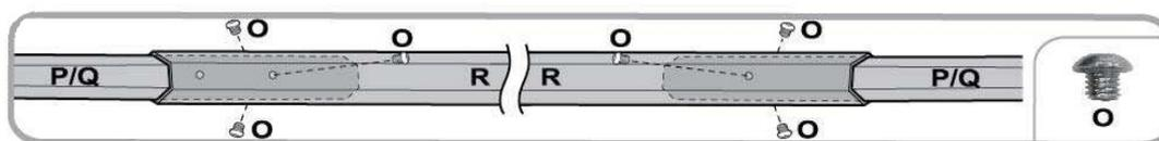
Pour fixer la connexion du tube **R** avec **P/Q**, serrez les trois vis **O** dans les trous du tube **R** comme illustré. Un recouvrement minimal de 20 cm est requis.
