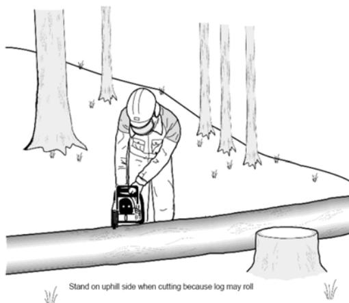
Figure BB.107 - Tronçonnage d'une bûche
