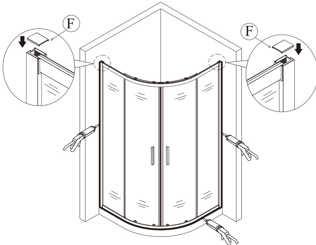
Aplicar silicón en el exterior del cuarto de ducha entre los perfiles y la pared; y entre el marco y el plato de ducha, para mejorar la impermeabilidad. Esperar 24hr después de aplicar silicón para usar.
