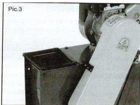
4) Placez la trémie au dessus de la garniture et alignez tous les trous. Fixez l'ensemble avec les boulons hexagonaux, les rondelles et les écrous.
