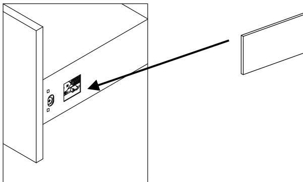
Cette vis de réglage permet de détacher la façade en cas de besoin
