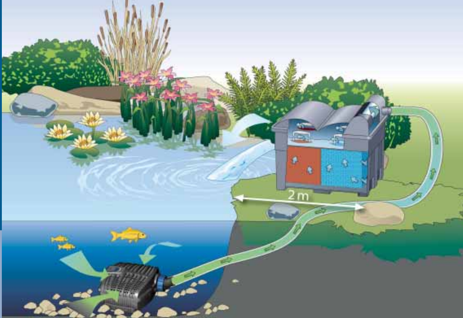
Représentation schématique : pompe pour filtres et ruisseaux AquaMax Eco Classic (START) en combinaison avec un filtre gravitaire OASE BioSmart (START)
