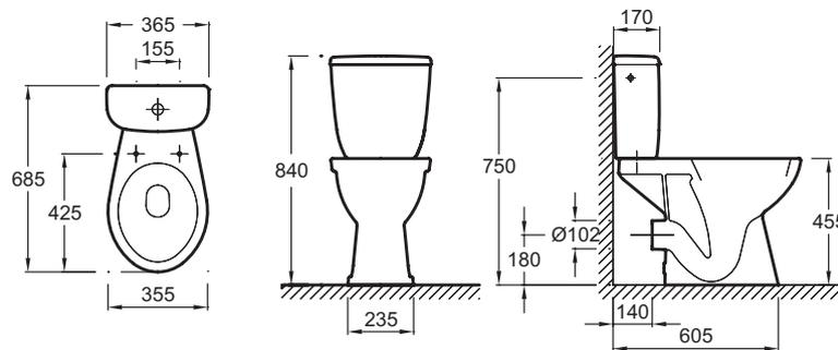
Descriptif CCTP : Cuvette surélevée, sortie horizontale (réservoir non inclus). E1730. Collection : BRIVE. DIMENSIONS : 68,50 x 35,50 cm. POIDS : 19 kg. MATÉRIAU : Céramique. TYPE D'INSTALLATION : Au sol. CONSOMMATION D'EAU : Standard 3/6 L. HAUTEUR : Surélevée/PMR. TYPE DE BRIDE : Ouverte (traditionnelle). BRIDE : Surélevée/PMR. PRODUIT INCLUS : (réservoir et abattant non inclus). Sortie horizontale.
