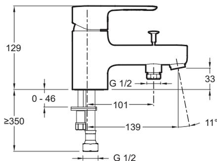
Description : Mitigeur bain-douche monotrou. E16044-4. Collection : JULY. Poids : 1,5 kg. Type d'installation : 1 trou. Normes et réglementations : NF : IC/A - ECAU : E3/1 C2 A3 U3 - Ge3. Débit (l/mn sous 3 bars) : 21 l/mn. Raccords : Avec flexibles d'alimentation. Mécanisme : Cartouche à disques céramique. Aérateur anti-calcaire.. Clapet anti-retour sur sortie douche.. Inverseur automatique verrouillable..
