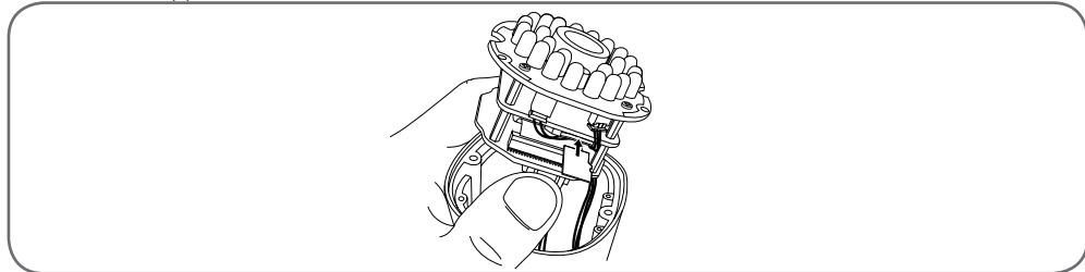
Voer de bovengenoemde stappen in omgekeerde volgorde uit om de camera weer te sluiten. Controleer of de pakking naar behoren is geplaatst om insijpeling van water te voorkomen.
