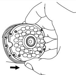
Retire la tarjeta electrónica tirando suavemente.
