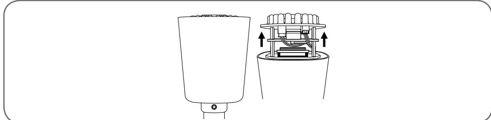
Führen Sie die MicroSDHC-Karte in das dafür vorgesehene Fach ein, ohne die Kabel und die Steckverbinder der Kamera zu lösen.
