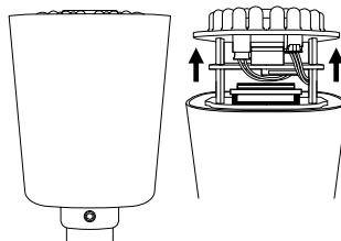
Introduzca una tarjeta microSDHC en el alojamiento previsto para ello sin desconectar los cables ni conectores de la cámara.
