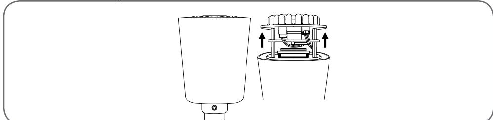
Insérez une carte microSDHC dans le logement prévu à cet effet sans débrancher les câbles et connecteurs de la caméra.
