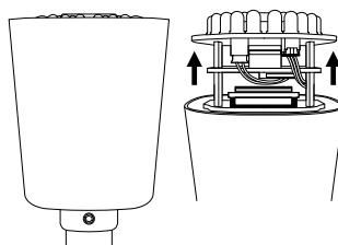
Inserire la scheda microSDHC nell'apposito alloggiamento senza scollegare i cavi e i connettori della telecamera.
