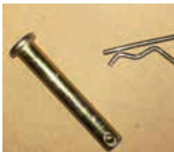
Une fois montée sur les demi-arbres, mettez les goupilles de verrouillage.
