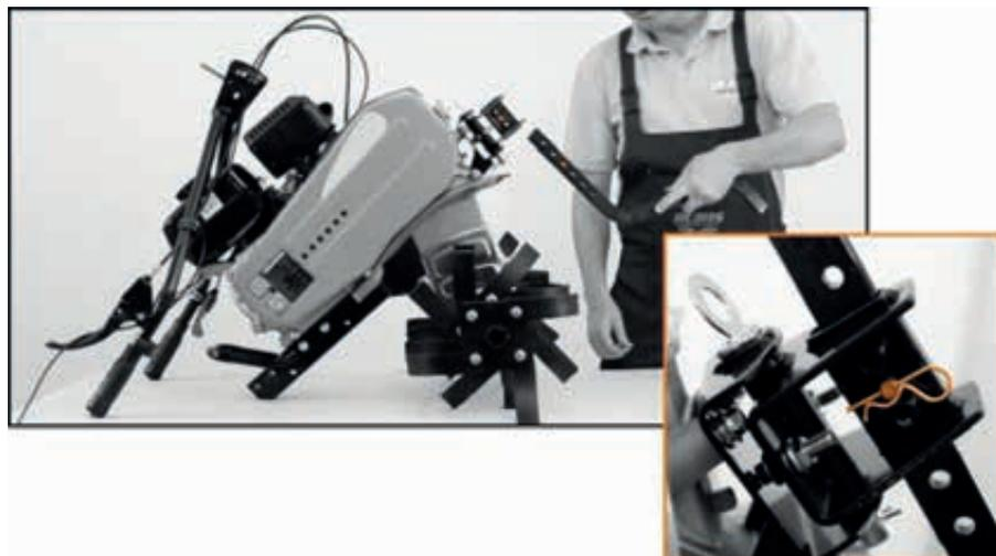
Vous montez le pic de terrage sur la chape arrière en utilisant un axe et goupille de bon diamètre (diam.10).
