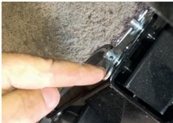
Il suffit d'enlever la première goupille, ensuite relever la roue et remettre la goupille dans le trou afin que la roue ne puisse plus descendre.
