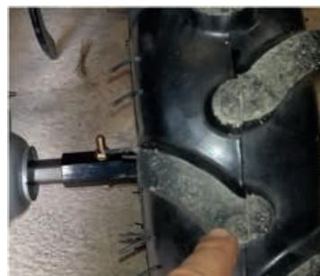
Le montage des roues métalliques est identique à celui des roues pneumatiques.
