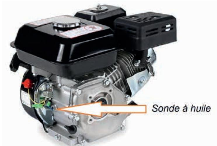
Une motobineuse trop inclinée peut également déclencher la sécurité. Le niveau doit toujours se faire ou se contrôler avec la motobineuse à l'horizontale.
