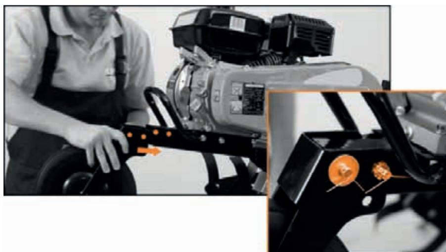
Montage de la roue de manutention à l'aide de l'axe et boulon fournis avec votre motobineuse.
