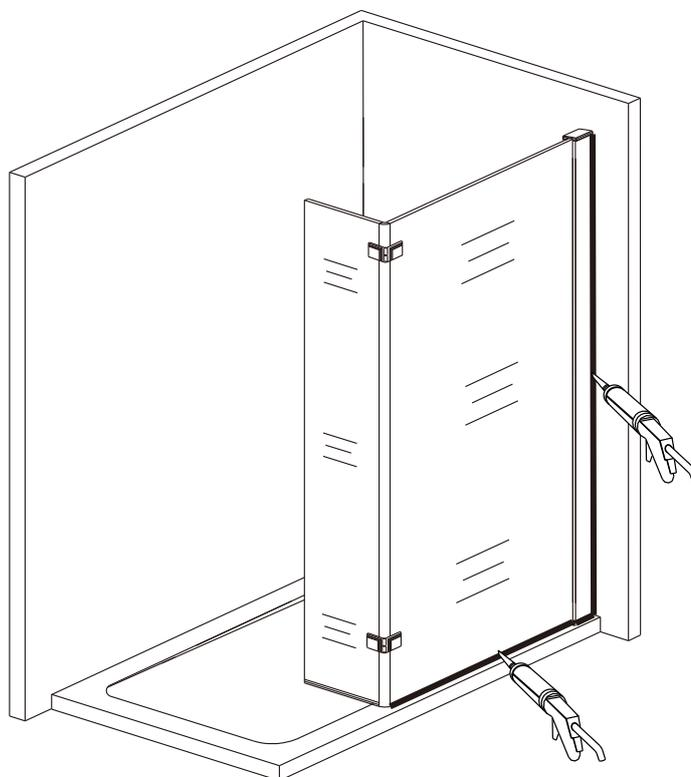
Applicare del silicone sull'estremità esterna della chiusura del box doccia (tra i profili a muro e muro, e tra i profili ed piatto doccia) per migliorare l'impermeabilizzazione. Dopo l'installazione, sono necessarie 24h per che il silicone si secchi prima di essere utilizzato.
