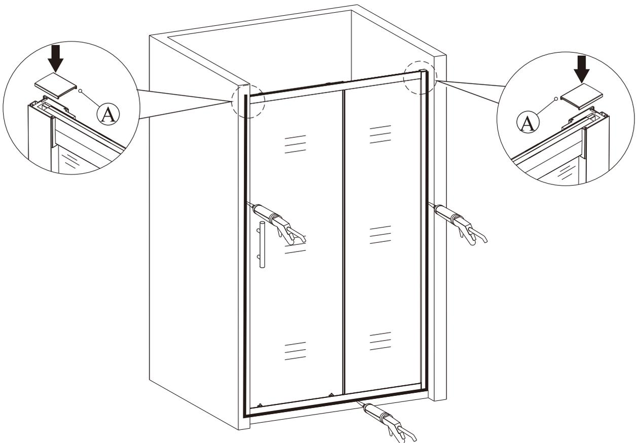
Bitte tragen Sie Sanitärsilikon von außen zwischen Wand und Wandprofil und Duschtasse und dem Profil auf der Duschtasse auf. Nach dem Auftragen muss das Silikon 24 Stunden trocken, bevor Sie Ihr Produkt das erste Mal nutzen können.
