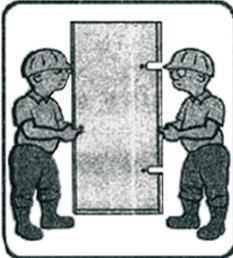
Die Scheiben nur in der Senkrechten Transportieren, bei waagerechter Lage können sie brechen. Übermäßiges anziehen der Schrauben kann Schäden oder Risse verursachen.
