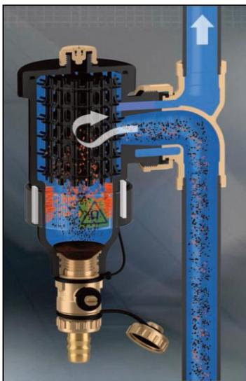
**La vitesse du flux est ralentie** à l'intérieur du corps, les particules en suspension sont séparées au contact de la grille intérieure et tombent au fond du bol.
