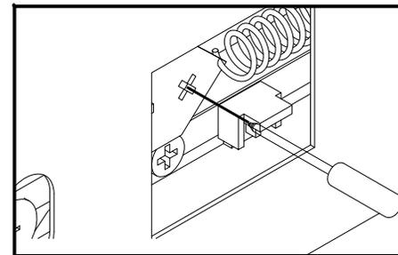
Cette vis de réglage permet de détacher la facade en cas de besoin
