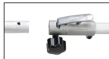
2). Serrez le boulon de verrouillage et insérez l'axe de transmission dans l'arbre principal. Relâchez la goupille de verrouillage et assurez-vous que la goupille de verrouillage s'engage dans le trou.
