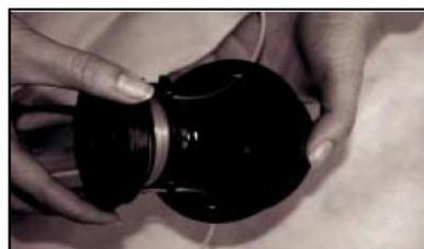
7. Faites passer les extrémités du fil dans les trous de la partie extérieure de la bobine.
