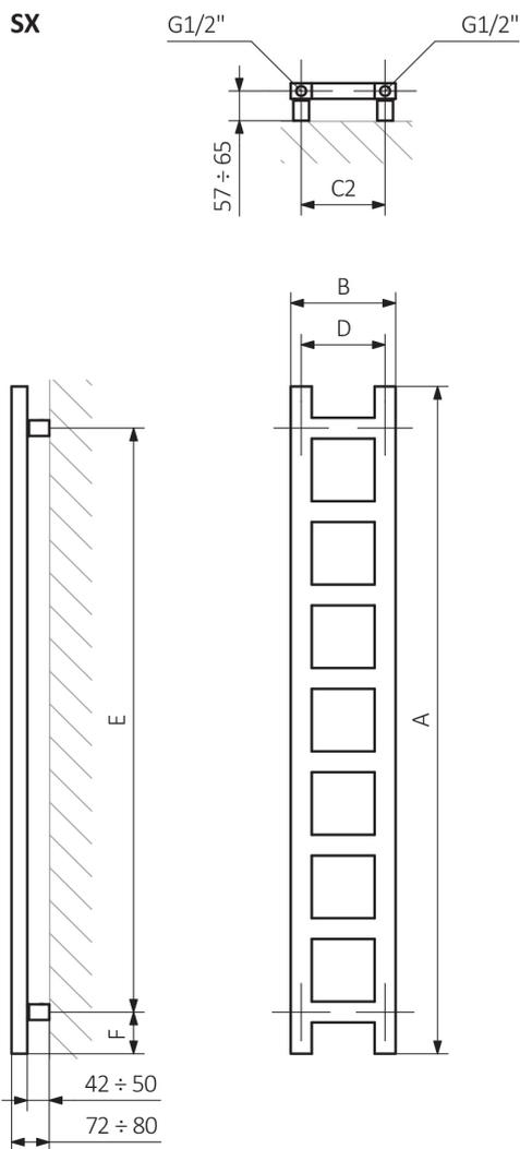
A – hauteur B – largeur C1-C5 – écartement des raccordements D – écartement des consoles en horizontal E – écartement des consoles en vertical F – distance de l'axe de la console inférieure au bord inférieur du collecteur
