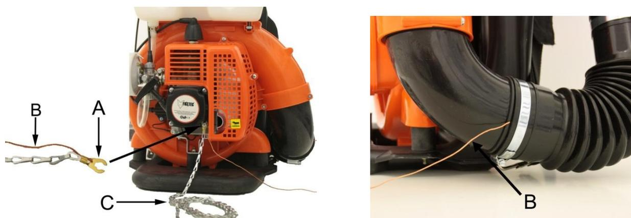
La chaîne de sécurité (C) doit être suspendue librement et doit toucher le sol pour être mise à la terre pendant le fonctionnement.
