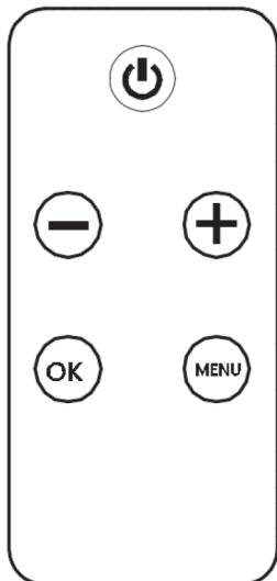
Il telecomando è compreso nel volume di consegna del dispositivo. Per poterlo utilizzare con il telecomando, l'interruttore A deve essere in posizione "I". Tutti i tasti del telecomando corrispondono ai tasti del pannello di controllo.
