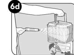
Nettoyez le panier de filtrage au moyen d'un jet d'eau.
