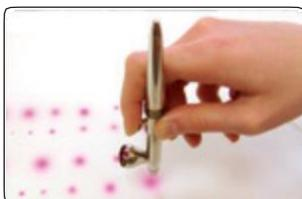
**Pulvérisation de points:** Recourir à la seconde main pour stabiliser. Commencer avec l'air, puis tirer prudemment la gâchette un peu en arrière. Pour de plus gros points, prendre plus de distance et utiliser plus de produit.
