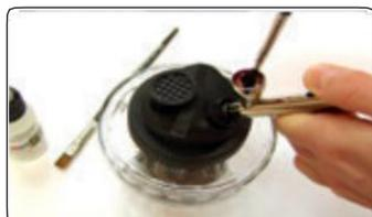
**Nettoyage intermédiaire:** Pulvériser la peinture dans l'appareil jusqu'à épuisement, détacher les résidus avec de l'eau et/ou un nettoyant approprié et à l'aide d'un pinceau/d'un coton-tige puis purger.
