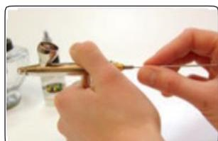
Placer la buse (C) dans la tête d'air (B) et visser. Visser le capuchon d'aiguille (A). Appuyer sur la gâchette (F) et introduire précautionneusement l'aiguille (I) jusqu'à la butée. Revisser le contre-écrou de l'aiguille (K) et la queue (L).
