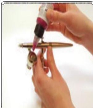
Toutes les peintures Airbrush ou laques usuelles de viscosité laiteuse conviennent, le cas échéant, la peinture doit être diluée en conséquence. Les appareils sont spécialement conçus pour l'utilisation de produits contenant des solvants.
