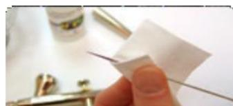
Retirer l'aiguille (I), la nettoyer au chiffon et au produit nettoyant. Contrôler que la pointe de l'aiguille ne présente pas de déformations.
