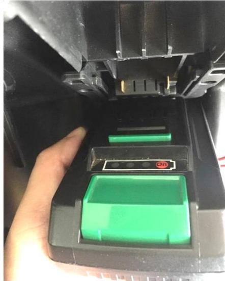
3. une batterie installée de façon permanente. Déclenchement avec le bouton vert.
