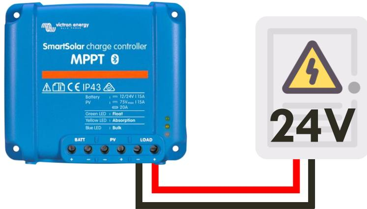
La sortie LOAD est bridée au courant maximale du régulateur.
