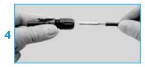
Introduire l'embout métallique par l'arrière de prise MC4 jusqu'à l'enclenchement
