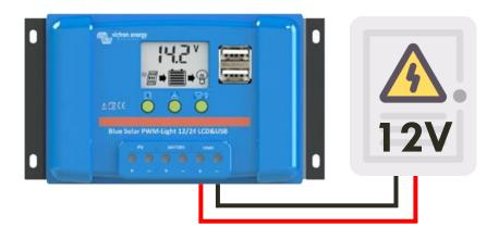
La sortie LOAD est bridée au courant maximale du régulateur.
