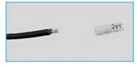
Insérer l'extrémité du câble dénudé dans la cosse M6/M8/Faston
