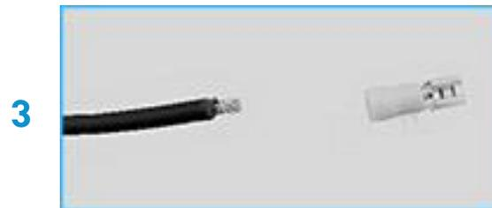
Insérer l'extrémité du câble dénudé dans la cosse M6/M8/Faston
