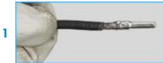
Insérer le câble dénudé jusqu'à ce que l'isolant bute sur l'embout métallique
