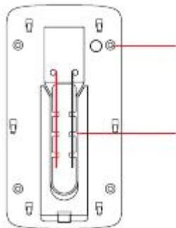
**1. Utilisez les vis du kit de montage pour fixer le support au mur**
