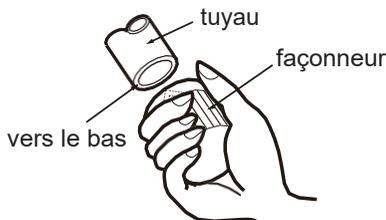
C : Mettre le tuyau isolant approprié
