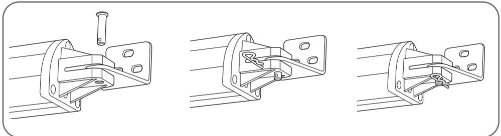
A l'aide d'une vis papillon, assembler la patte de fixation portail avec le vérin. Utiliser le trou correspondant à la distance D (voir tableau p.12).
