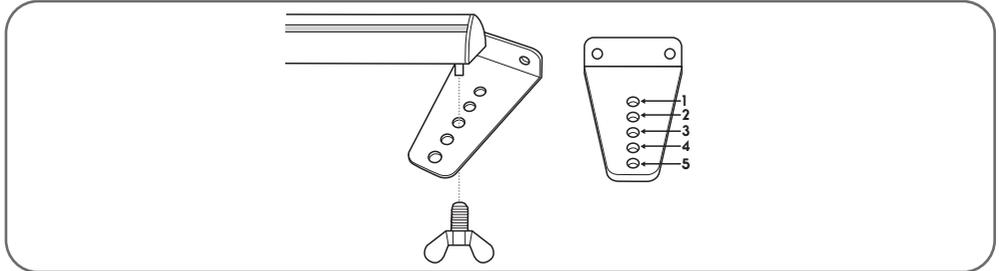
Fermer le portail en le plaquant bien sur sa butée centrale puis faire pivoter le vérin afin de poser la base de la patte de fixation portail sur le portail. Marquer ensuite l'emplacement des 2 trous de fixation sur le portail.
