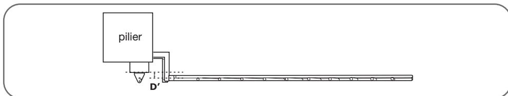
Déterminez l'angle d'ouverture de chaque battant en fonction des données du tableau suivant. L'angle d'ouverture peut être différent pour chaque battant mais ne doit jamais être inférieur à 40°.
