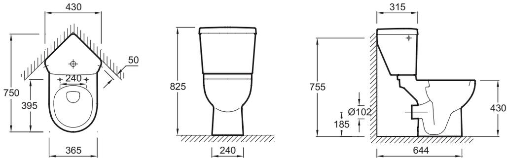
Description : Pack WC d'angle, sortie horizontale. E0373. Collection : ODÉON UP. Dimensions : 75 x 43 cm. Poids : 43 kg. Matériau : Céramique. Type d'installation : Au sol. Normes et réglementations : NF. Consommation d'eau : Standard 3/6 L. Hauteur : Confort. Type de bride : Fermée. LIVRÉ AVEC : Abattant thermodur E70009, charnières métal inox à fixation rapide. Alimentation latérale.
