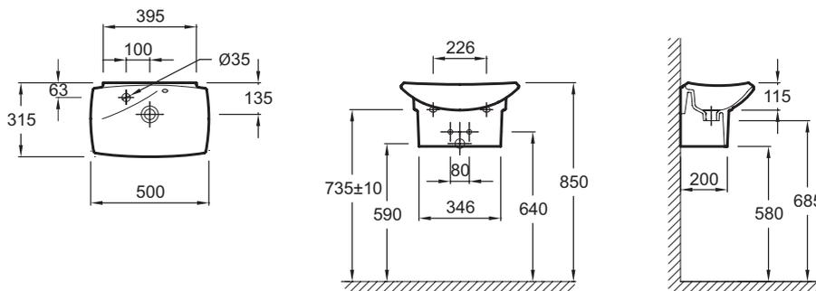
Description : Lave-mains 50 cm. E1025. Collection : ESCALE. Dimensions : 50 x 31,50 cm. Poids : 11 kg. Matériau : Céramique. Type d'installation : Autoportant ou peut être monté sur un meuble spécifique. Percement et pré-perçement robinetterie : Percé 1 trou de robinetterie. Fixations : Par 2 goujons non fournis. ROBINETTERIE CONSEILLÉE : Le mitigeur élégant et racé Margaux et son levier joystick ou le mitigeur Purist au design audacieux.
