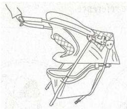
3. Insérez la roue avant sur le cadre jusqu'à ce que le bouton de verrouillage sur la roue avant ressorte.
