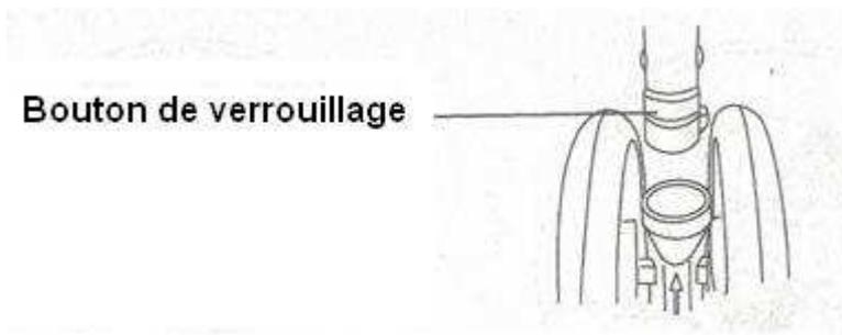
4. Placez les roues arrière, la rondelle, le clip, le cache sur l'axe principal. Ensuite, placez l'ensemble sur le cadre jusqu'à ce que le bouton ressorte. (Pour démonter, appuyez sur le bouton en retirez l'ensemble).
