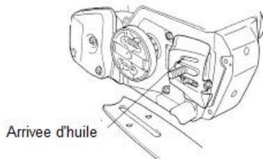
**d. Nettoyage du filtre à huile et du filtre à carburant**
