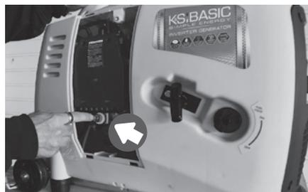
2. Appuyez 5-6 fois sur la pompe pour pomper le carburant dans le système de carburant.
