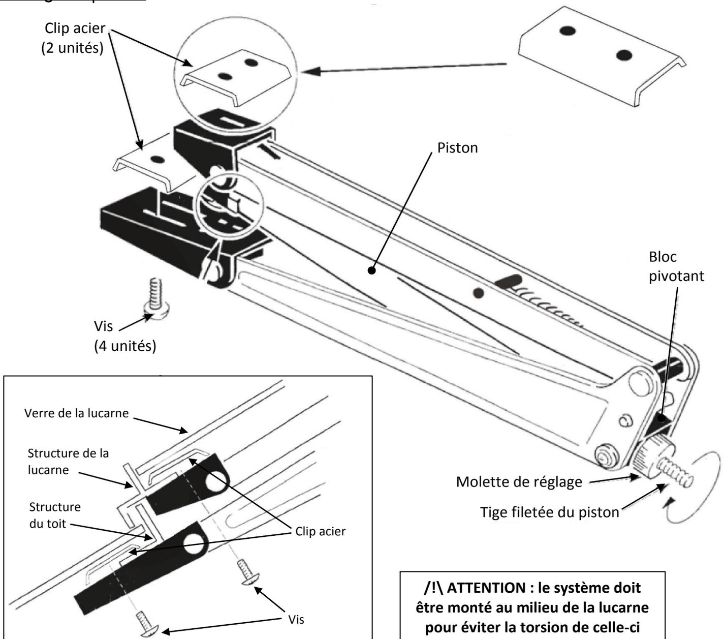
**/!\ ATTENTION : le système doit être monté au milieu de la lucarne pour éviter la torsion de celle-ci**
