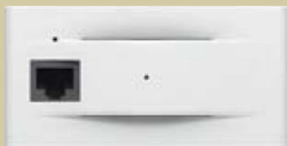
Point d'accès Wi-Fi (802.11 a+b/g dual band) équipé d'une prise RJ 45
