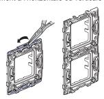
Pour réaliser une installation en boîte d'encastrement multipostes entraxe 57 mm.
