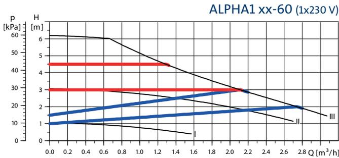
L'ALPHA1 est livré pré-réglé usine en position intermédiaire : Pression **proportionnelle** (90 % des installations de chauffage domestique sont concernées).
