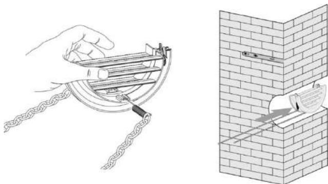
7. Assurez-vous que les chaînes de fixation sont placées sur le côté intérieur de la grille de protection extérieure. Pliez ensuite la grille en deux. Faites glisser la grille à l'extérieur à travers l'orifice d'entrée ou de sortie d'air.
