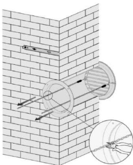
11. Soulevez l'appareil, alignez les trous de suspension se trouvant sur la façade arrière avec les crochets du rail de suspension et déposez doucement l'appareil sur les crochets. Dans le même temps, faites glisser le tuyau de drainage à travers le trou de drainage jusqu'à l'extérieur.
