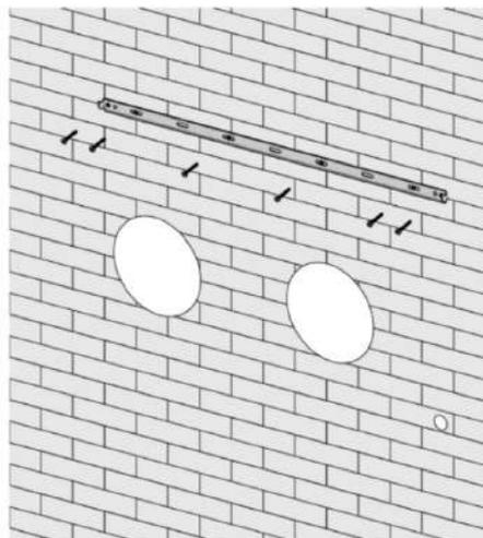
5. Roulez les feuilles plastiques pour former un tube et introduisez-les de l'intérieur dans les trous de 180 mm précédemment percés. Assurez-vous que les tubes sont au ras de la paroi intérieure.
