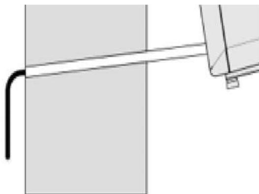
2. Percer un trou pour le passage du tuyau de drainage à l'aide d'un foret de 20mm. Assurez-vous que le trou est incliné vers le bas (min. 5 degrés) afin que l'eau puisse s'écouler correctement.
