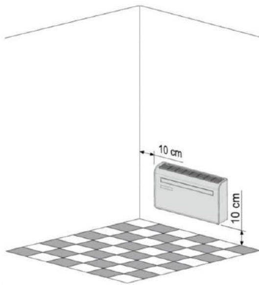
Placez l'appareil sur un mur plan et suffisamment robuste. Assurez-vous qu'il n'existe aucun obstacle sur la face externe du mur (Tuyaux, câbles, etc...) Veillez à ce que l'appareil ne soit pas placé contre des objets qui pourraient obstruer l'entrée et la sortie d'air, comme des meubles ou des rideaux, car cela risquerait d'affecter considérablement ses performances et présenter un risque d'incendie :
