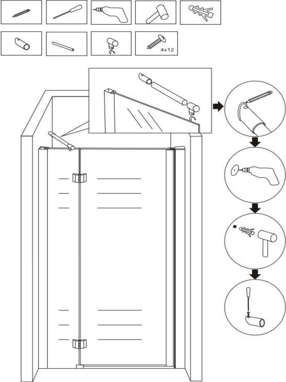
Versiegeln sie zu guter Letzt das Wand-Glas und die Wandprofile von außen mittels Silikon
