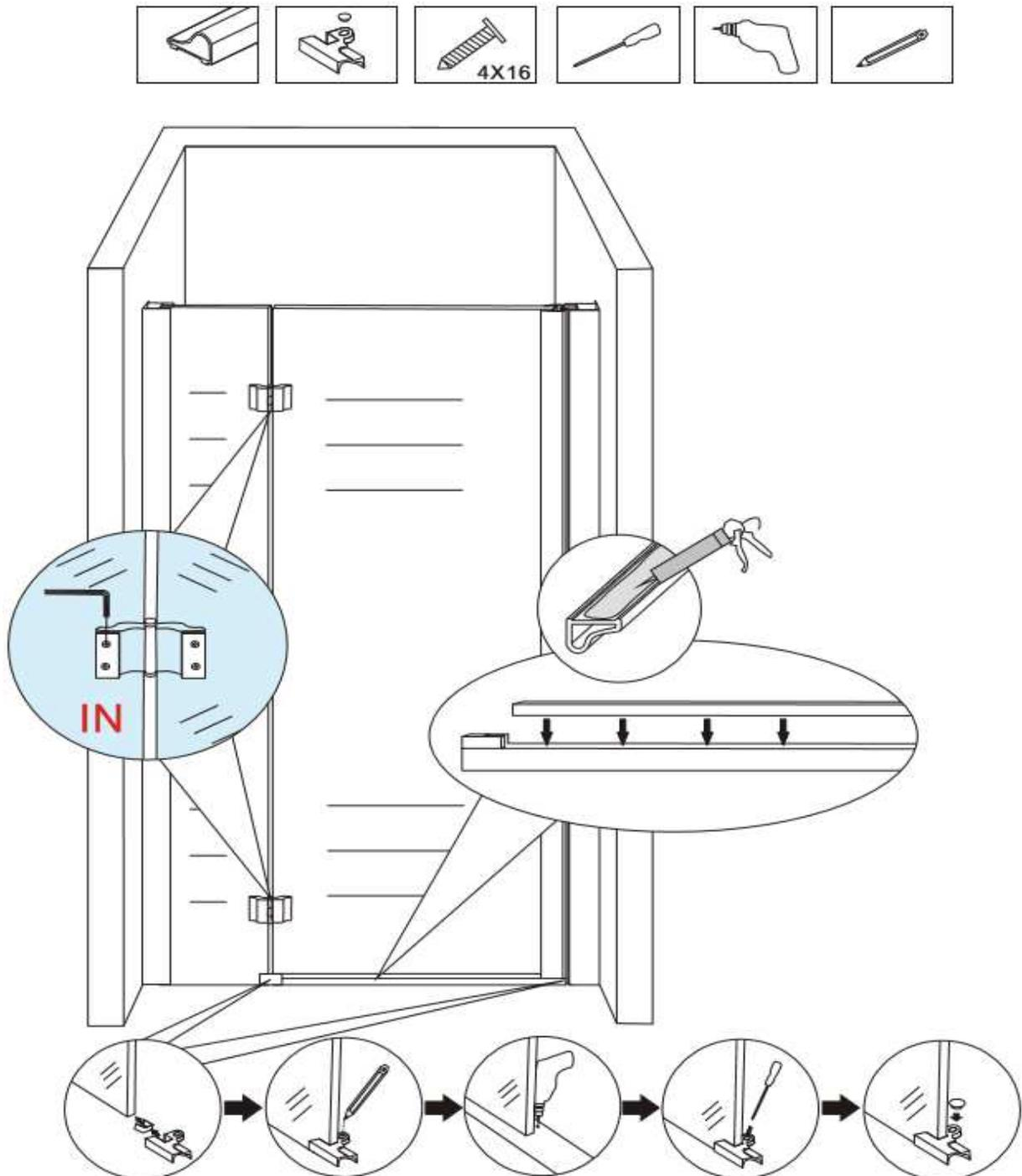
1. Richten Sie die Duschabtrennung aus, bohren Sie anschließend mit dem 3mm Bohrer an den vorgesehenen Stellen, von außen, durch das Wandprofil
