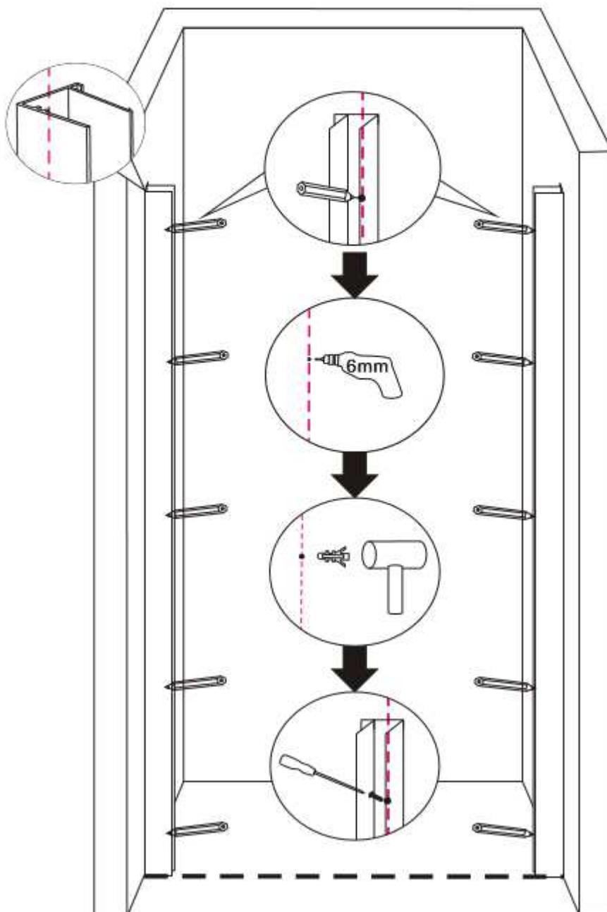
Bringen Sie nun die Dichtleisten entsprechend der Abbildung am Tür-Glas an, die vertikalen Dichtleisten werden von oben auf „stoß“ gesenkt.
