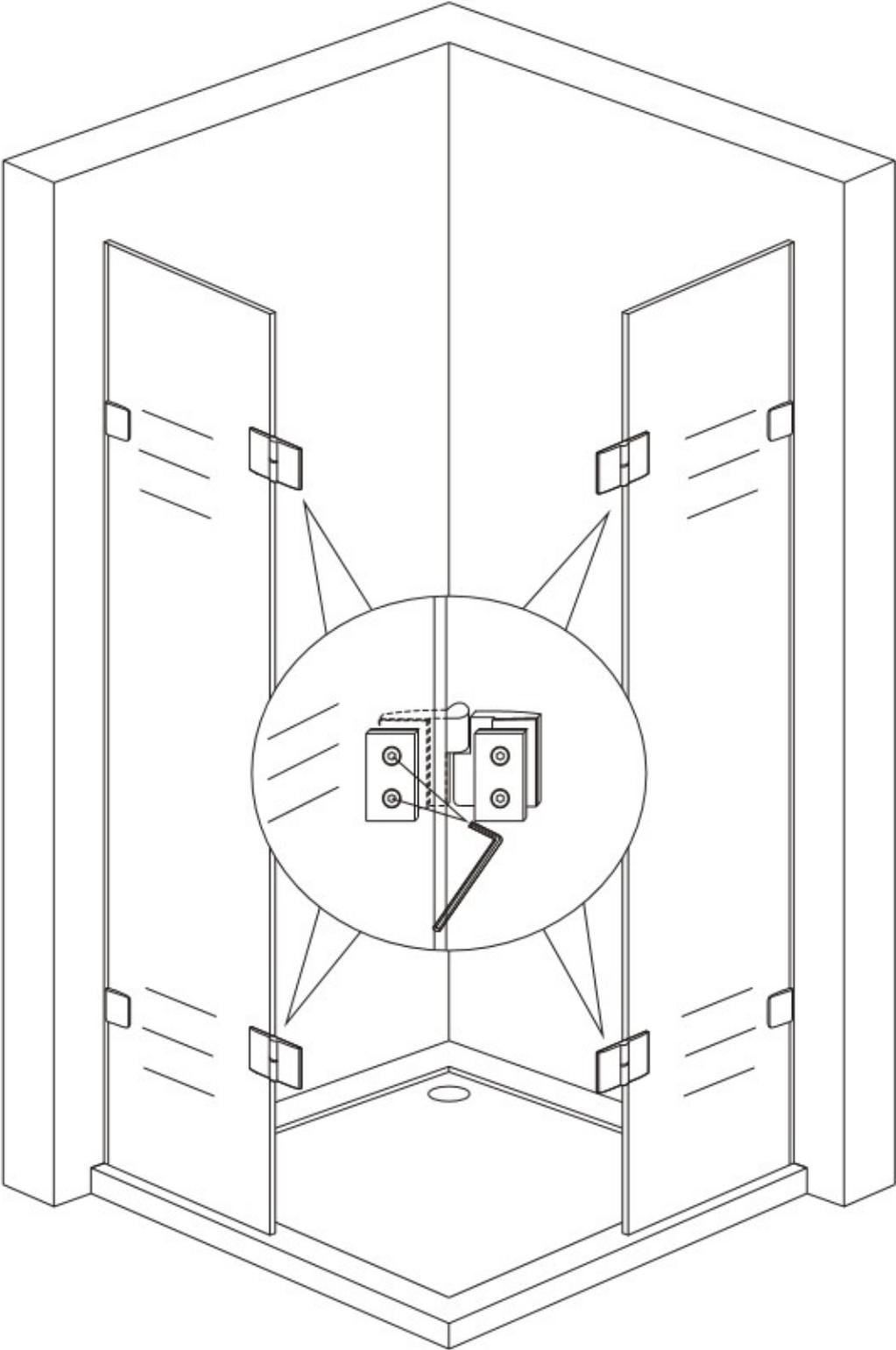
Bringen Sie nun die Dichtleisten an den Tür-Gläser entsprechend der Abbildung an. Die vertikalen Magnetleisten werden von oben auf stoß gesenkt.
