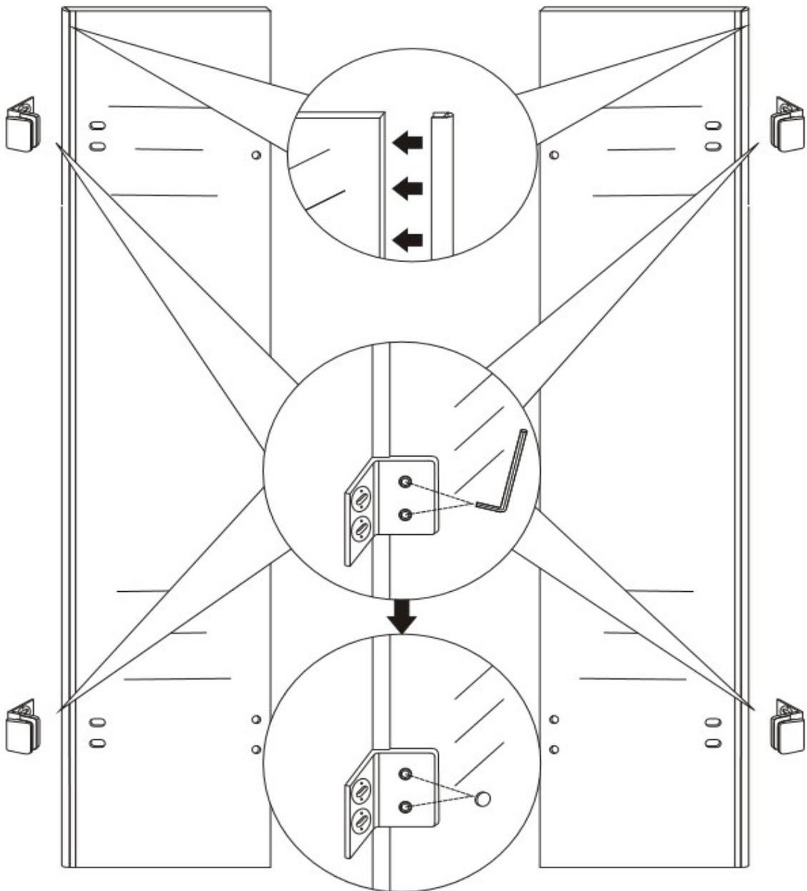
1. Stellen Sie nun Die Wand-Gläser auf und markieren Sie die Bohrlöcher auf der Installationslinie, nehmen Sie eine Wasserwaage zur Hilfe.
