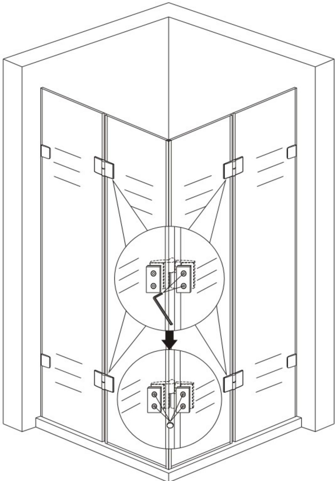
Bringen Sie die Stabilisationsstangen entsprechend der Abbildung an
