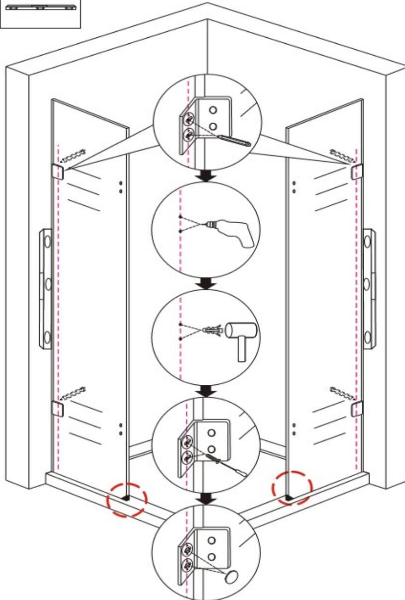
Lassen Sie bei diesem Vorgang den Kantenschutz am Glas
