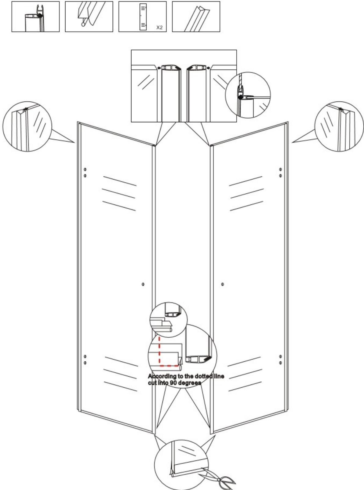
Schneiden Sie mittels einer Schere aus der unteren Türdichtung jeweils einen 90 Grad Winkel für die Magnetleisten heraus
