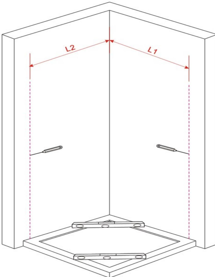
1. Bringen Sie die vertikalen Dichtleisten (Wandanschlagsseite an den beiden Wand-Gläsern an
