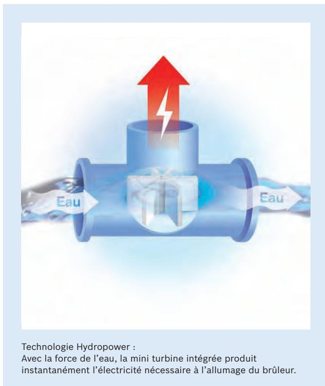
Technologie Hydropower : Avec la force de l'eau, la mini turbine intégrée produit instantanément l'électricité nécessaire à l'allumage du brûleur.
