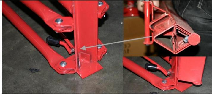
3. Attachez la poignée à la roue du treuil. Serrez la vis puis redévissez-la légèrement pour que la poignée puisse tourner librement.
