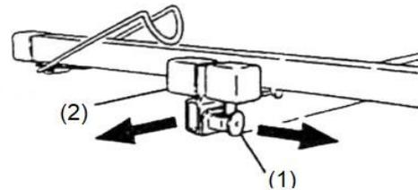
**Important :** Ne chargez jamais une cloison sèche ou n'utilisez jamais le lève-panneaux si la goupille de sécurité n'est pas engagée à une de ces trois positions ou si les stabilisateurs sont allongés à plus de 80 cm. Pour éviter de les endommager, rétractez toujours les stabilisateurs avant de transporter ou d'entreposer le lève-panneaux.
