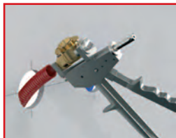
Raccordement à glissement
