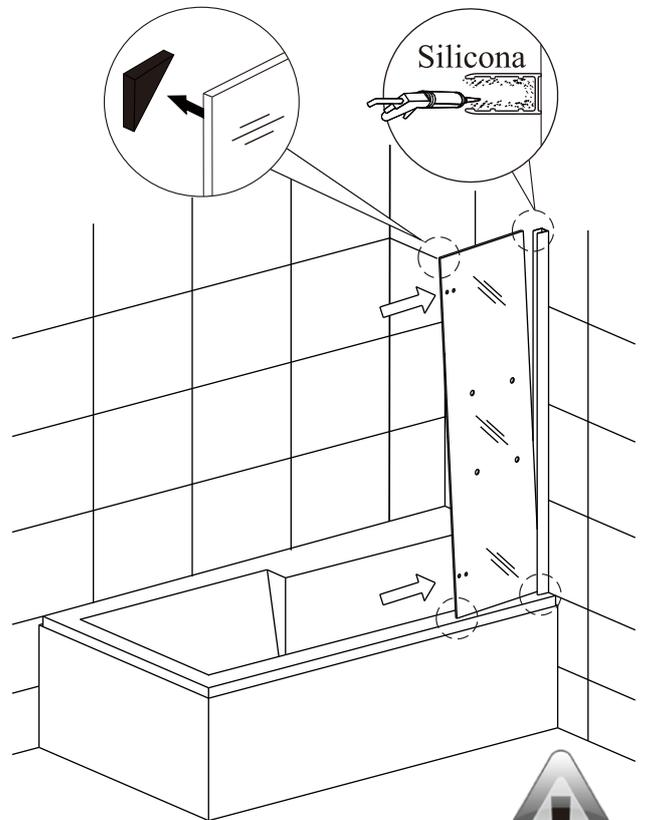
Matener puestas las protecciones esquinas del cristal, quitar al momento de montar el cristal e instalar los otros accesorios.
