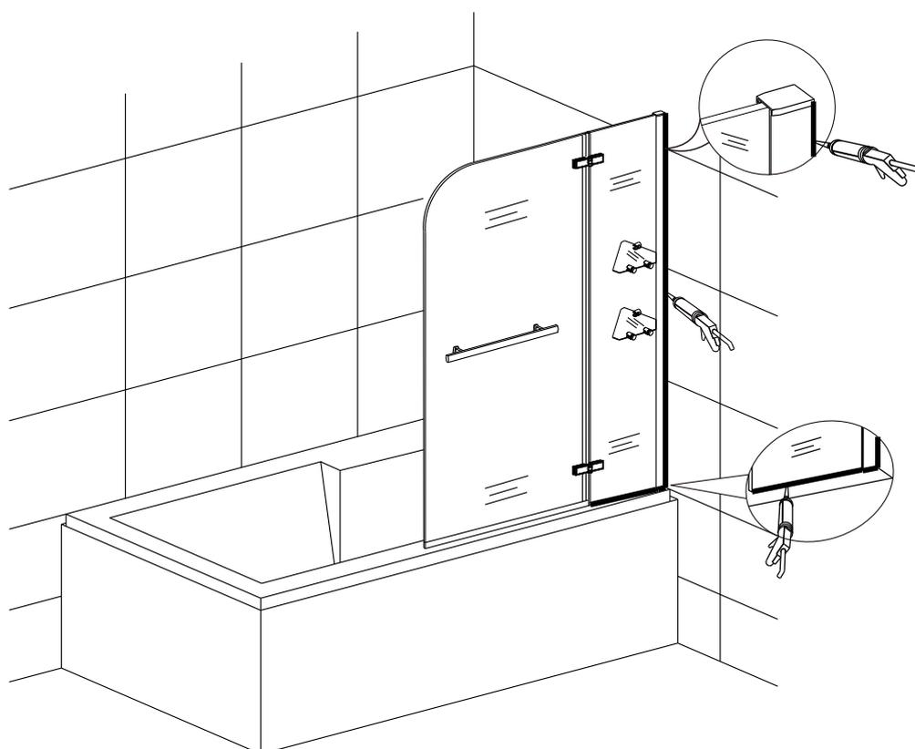
Aplicar silicón en el exterior de la pantalla de cristal entre los perfiles y la pared; y entre el marco y la bañera, para mejorar la impermeabilidad. Esperar 24hr después de aplicar silicón para usar.
