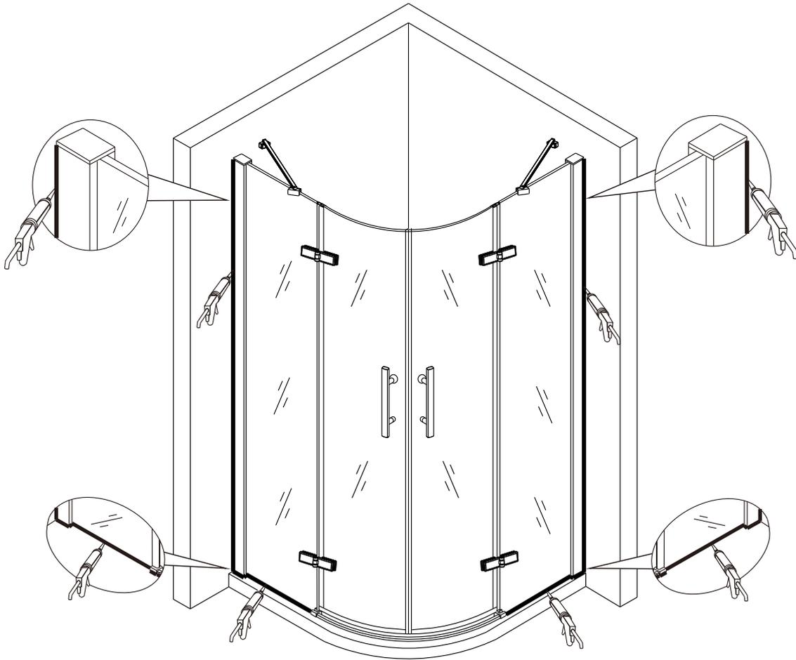
Aplicar silicón en el exterior del cuarto de ducha entre los perfiles y la pared; y entre el marco y el plato de ducha, para mejorar la impermeabilidad. Esperar 24hr después de aplicar silicón para usar.
