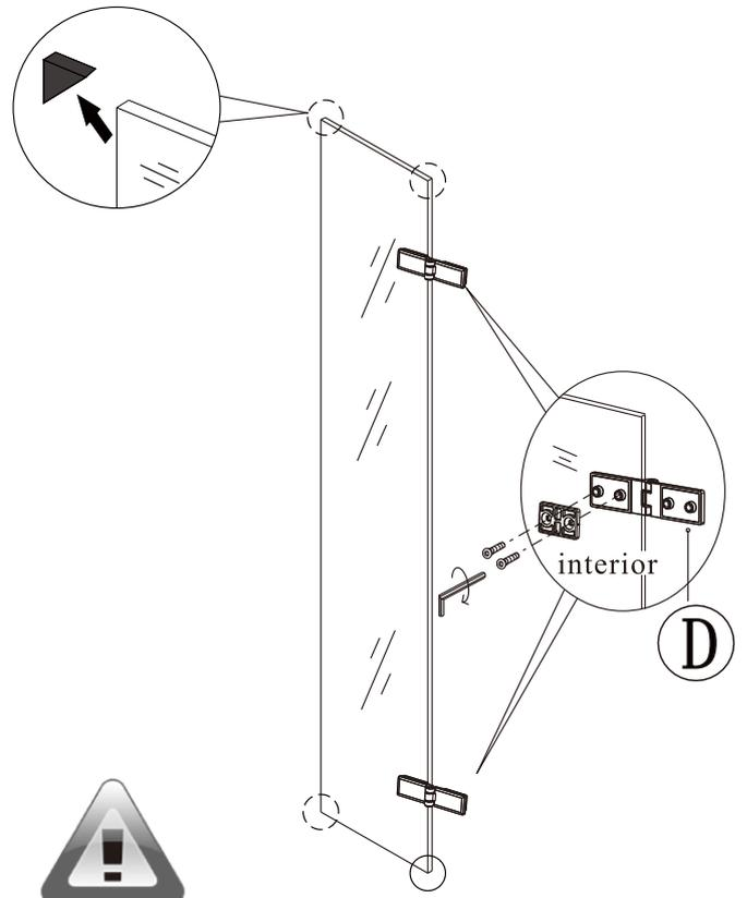
Matener puestas las protecciones esquineras del cristal, quitar al momento de montar el cristal e instalar los otros accesorios.
