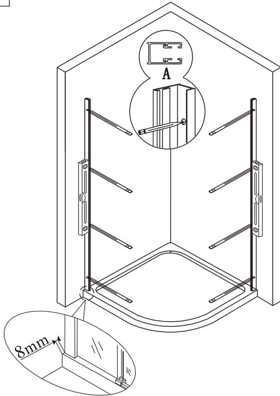
Instalar el perfil de pared por lo menos 8 mm del borde del plato de ducha, así dar espacio para instalar el accesorio de prevención de salida de agua.
